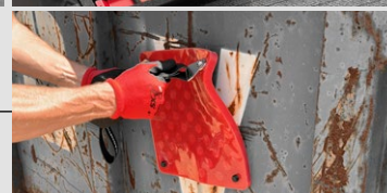
Entfernung des Leckdichtkissens
