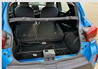
Teplotní alarm umístěný v zavazadlovém prostoru vozidla
