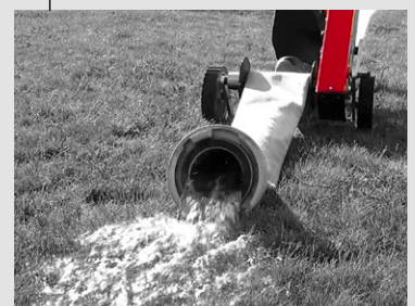
Použití navíječe při vypouštění zbytkové vody z požární hadice
