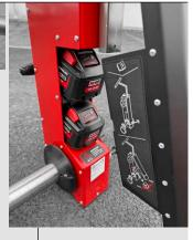
Elektromotorischer Antrieb mit Akkubatterie
