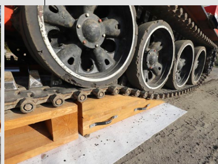
Detail nájezdu pásového vozidla na dřevěnou rampu
