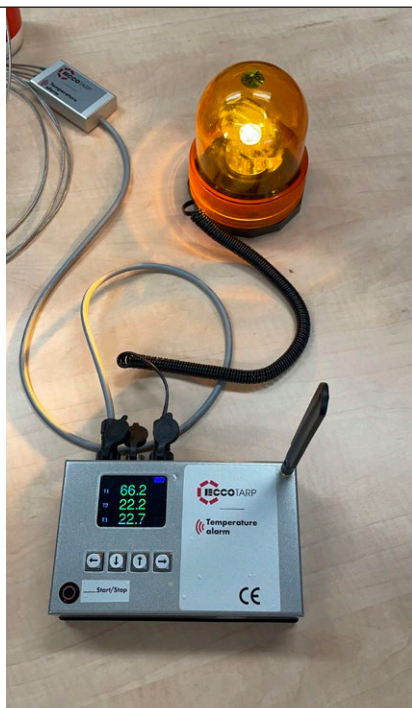
Maják ohlašující překročení stanovené teploty
