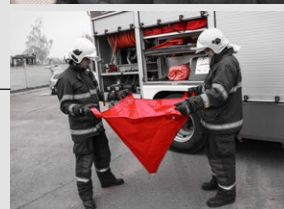
Pro manipulaci slouží 4 ucha umístěná v rozích trychtýře
